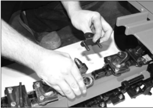
12.5.6 Nun die Fräsplatte auf das Verbindungsglied mit Schrauben und Muttern, wie in den nächsten vier Abbildungen gezeigt, montieren.
