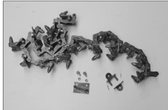
C Fräskette mit Verbindungsglied, 2 Schrauben und Muttern, 2 Splinte
