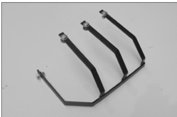
B Sicherheitsbügel der Frässhnecke
