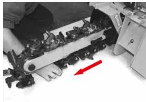
12.5.2 Fräskette verbinden, dabei beide Enden der Kette nach oben in die Mitte des Fräskettenarms ziehen.
