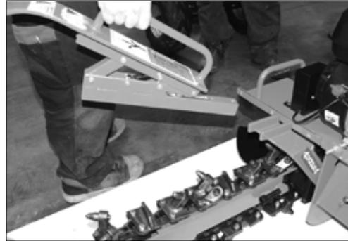
12.7.2 Räumler mit zwei Schrauben an der Maschine befestigen.
