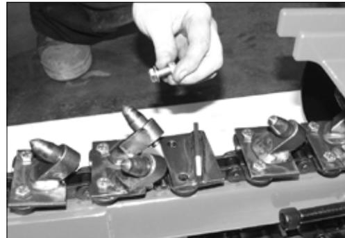
12.5.5 Sind beide Teile zusammen gesteckt, dann müssen diese mit den beiden Splinten gesichert werden.
