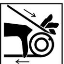
Rotierende Teile können Hände, Füße, Haare, Kleidungsstücke oder Schmuck berühren und sich darin verfangen. Halten Sie bei laufendem Motor genügend Abstand zu allen rotierenden Teilen. Direkt mit dem Motor verbundene Gerätekomponenten wie Messer, Riemenscheiben, Zahnräder und dgl. müssen geschützt und sicher befestigt sein.
