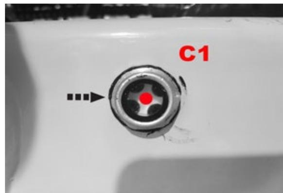
**Am Schauglas (C1) können Sie den Ölstand ablesen. Füllen Sie Öl bis zum roten Punkt, der sich in der Mitte des Schauglases befindet. Dann ist der max. Füllstand erreicht. Ein niedriger Ölstand kann die Ölpumpe beschädigen. Ein zu hoher Ölstand würde die Temperatur im Hydrauliksystem zu stark anheben und so die Bauteile beschädigen.**
