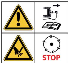
Instandsetzungs-, Einrichtungs-, Wartungs- und Reinigungsarbeiten nur bei abgeschaltetem Antrieb und stillstehendem Werkzeug vornehmen.
